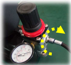
(2) ゴムホースの取り付け
